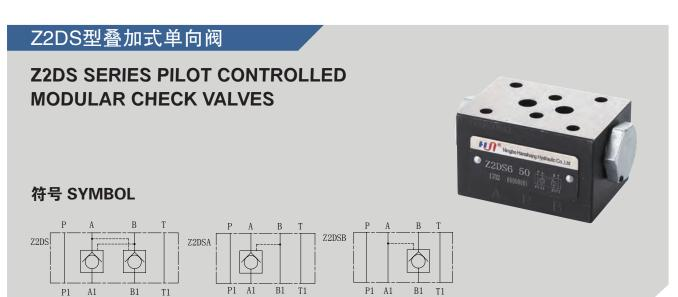
Z2DS型单向阀是叠加式液控单向阀,它可用于关闭一个或两个 工作油口且无泄漏持续工作时间长,稳定性好。
