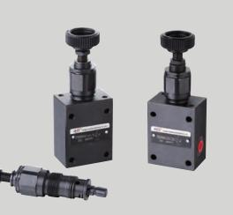
PBD型溢流阀是直动式座阀,用以限制系统压力,其 结构可分为锥阀(压力至40Mpa)和球阀结构,压力等级分 别为2.5; 5; 10; 20; 31.5; 40。 该阀体积小、结构紧凑、流量特性好、噪音小、压力 稳定、广泛应用在小流量系统中,可作为安全阀及遥控阀 等。
